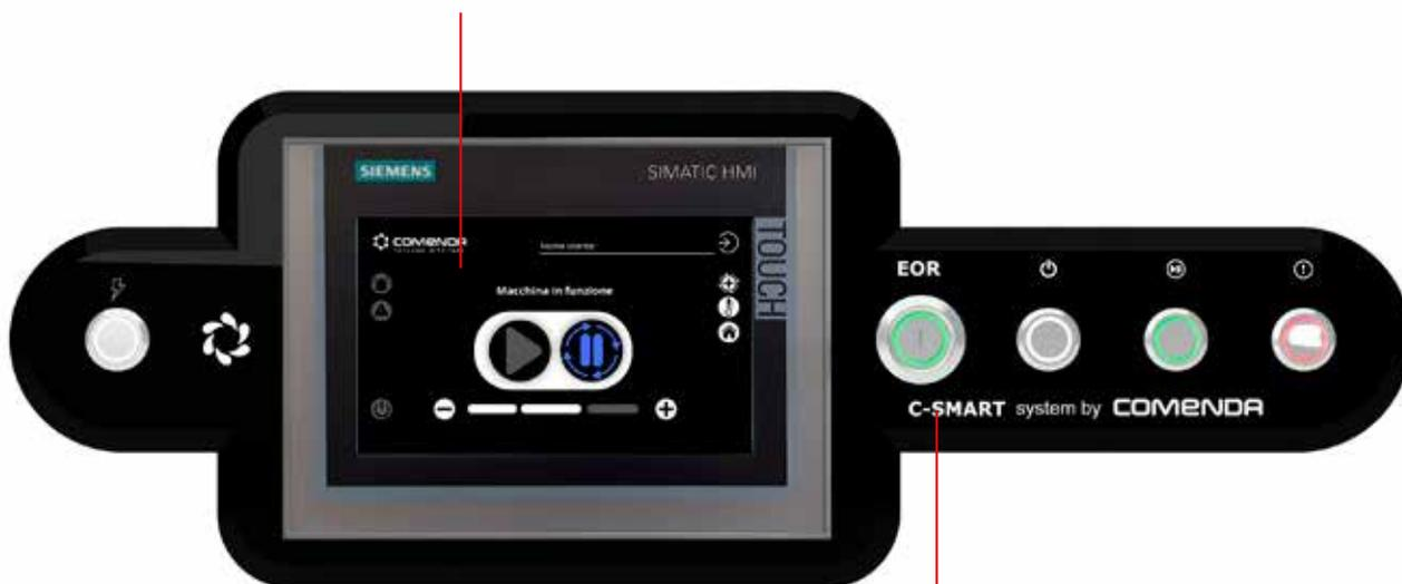
**Simple, intuitivo y universal, EOR es un control electromecánico de activación con llave.** Permite incluso al operador menos experto reducir las operaciones para configurar el lavado de forma autónoma, incluso en caso de desconocimiento total del uso de la máquina o de un mal funcionamiento electrónico.
