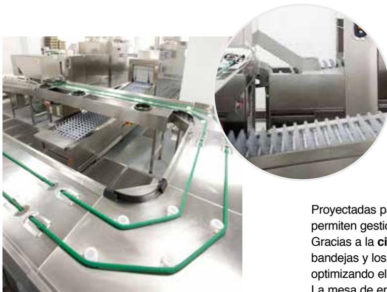
Proyectadas para un hospital, estas dos soluciones nos permiten gestionar un gran número de comidas. Gracias a la **cinta polycord** y nuestro **túnel LVP**, las bandejas y los cubiertos se cargan de forma automática, optimizando el personal en la cocina. La mesa de entrada rebajada del **túnel NE**, permite trabajar de una forma más cómoda.
