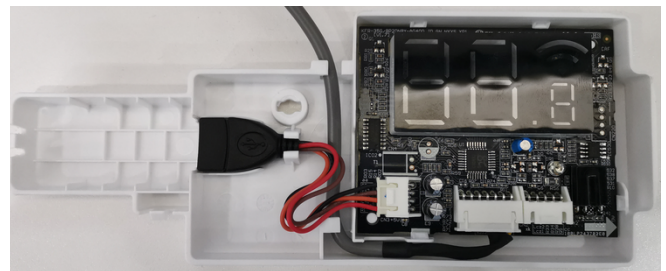
Imagen 4 – Colocación del cable
