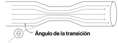
Representación de un estrechamiento por el que circula el flujo de aire.
