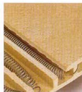
Detalle de las resistencias en espiral insertadas en el plano de cocción
